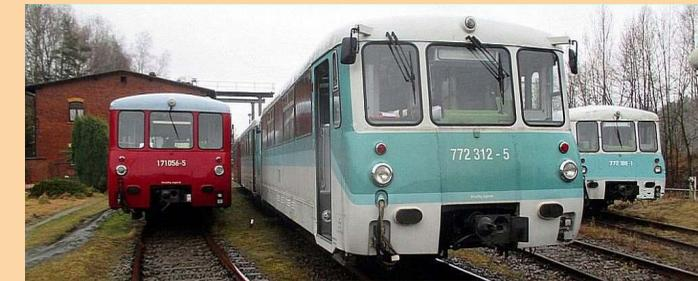
Ab Anfang der 1990er Jahre erhielten die LVT im RAW Halle eine Modernisierung. Dabei wurde eine neue Motorenanlage mit neuem Getriebe eingebaut. Zeitgemäße stoffbezogene Sitzbänke im typischen Regionalbahn-Grün sowie die neue Innenraumbeleuchtung und eine zusätzlich eingebaute durchgehende Zugbeschallung sorgen für besseren Reisekomfort.
